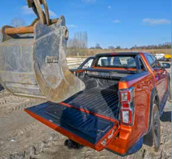
Baklämmen är låsbar och lastutrymmet är helt klätt i plastmaterial. Lastutrymmets djup är 490 mm.
