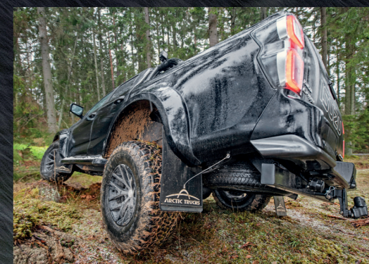
Den längre fjädringsvägen, den högre markfrigången och de större hjulen ger avsevärt bättre terrängegenskaper.
